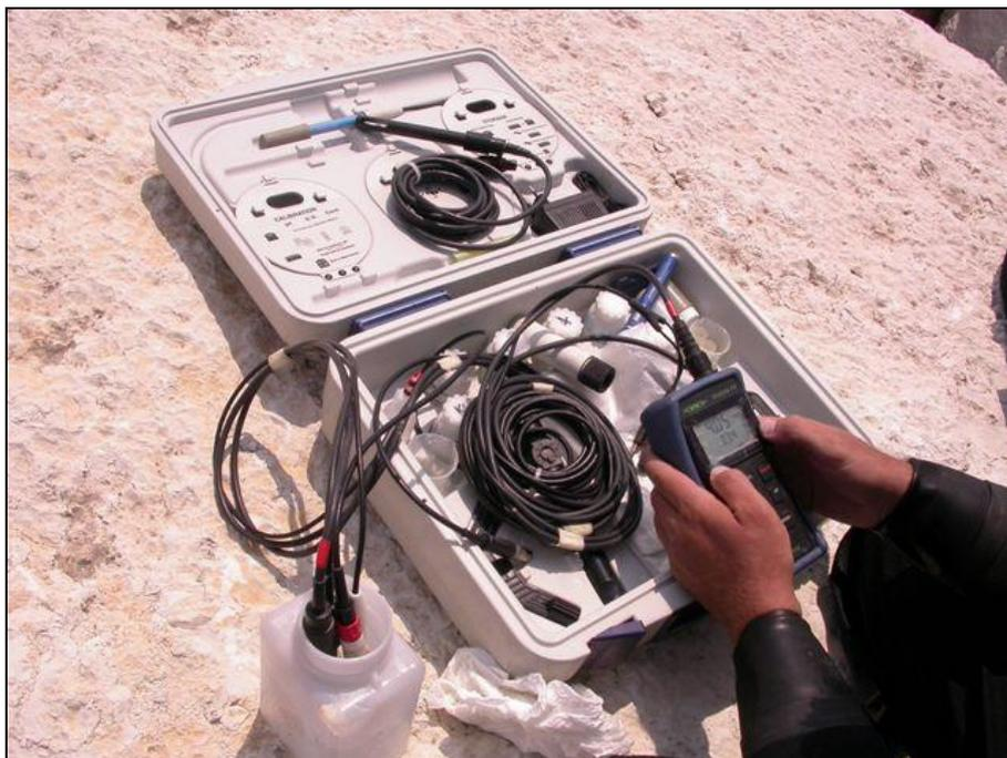
Fig. 6.15 - Rilevamento dei principali parametri chimico-fisici delle acque, quali temperatura, salinità ed ossigeno disciolto.
