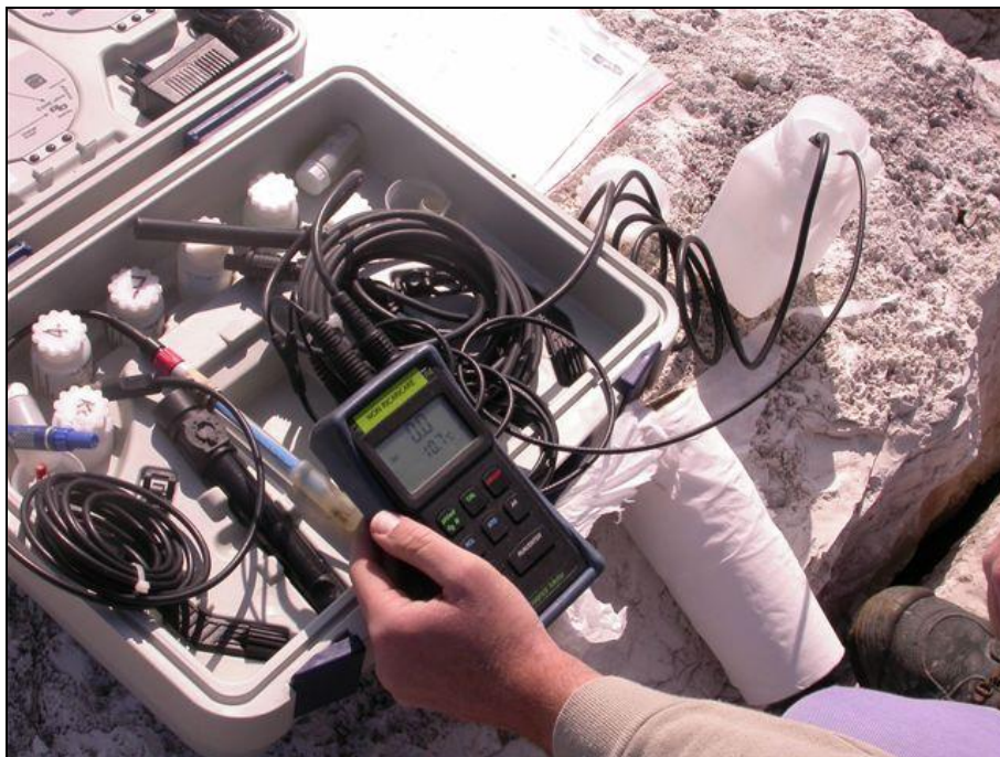
Fig. 7.16 - Rilevamento dei principali parametri chimico-fisici delle acque, quali temperatura, salinità ed ossigeno disciolto.
