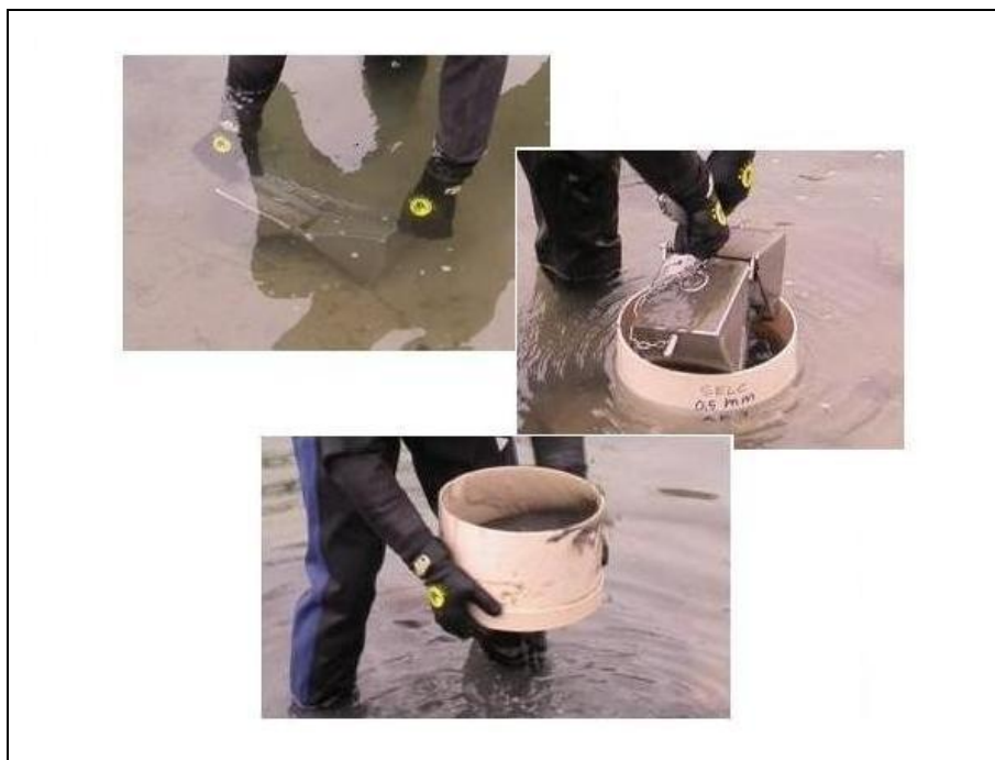
Fig. 7.2 – Stazione 1: fasi di campionamento con benna e successivo setacciamento delle repliche di endofauna presso il fossato dell'ex-forte.
