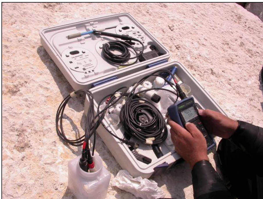
Fig. 6.13 – Rilevamento dei principali parametri chimico-fisici delle acque, quali temperatura, salinità ed ossigeno disciolto.
