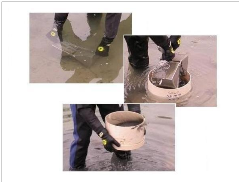
Fig. 6.2 - Stazione 1: fasi di campionamento con benna e successivo setacciamento delle repliche di endofauna presso il fossato dell'ex-forte.
