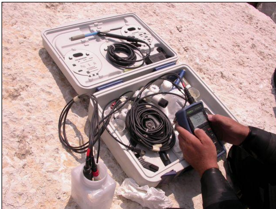
Fig. 6.16 - Rilevamento dei principali parametri chimico-fisici delle acque, quali temperatura, salinità ed ossigeno disciolto.
