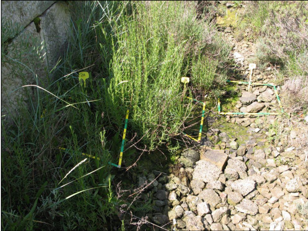
Foto 6.5 - Stazione 2 : posizionamento dei tre campioni lungo un transetto rivolto dal margine della diga (campione A) verso la parte più infossata della pozza di sifonamento (campione C).
