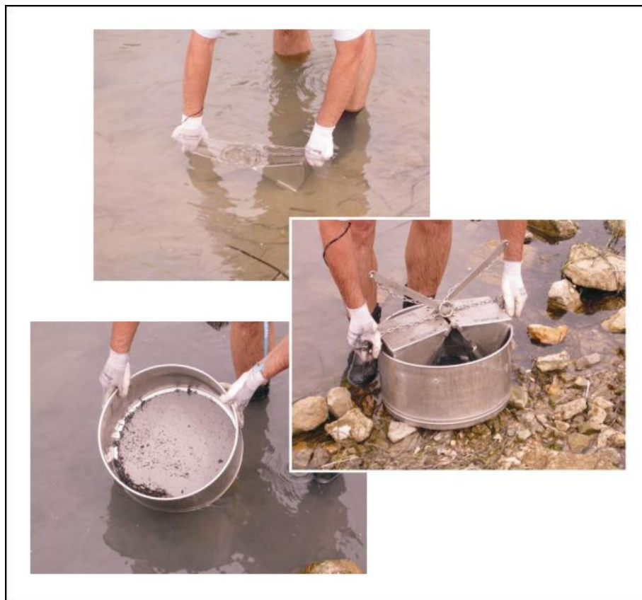
Foto 6.2 - Stazione 1 : fasi di campionamento con benna e successivo setacciamento delle repliche di endofauna ed epifauna presso il fossato dell'ex-forte.
