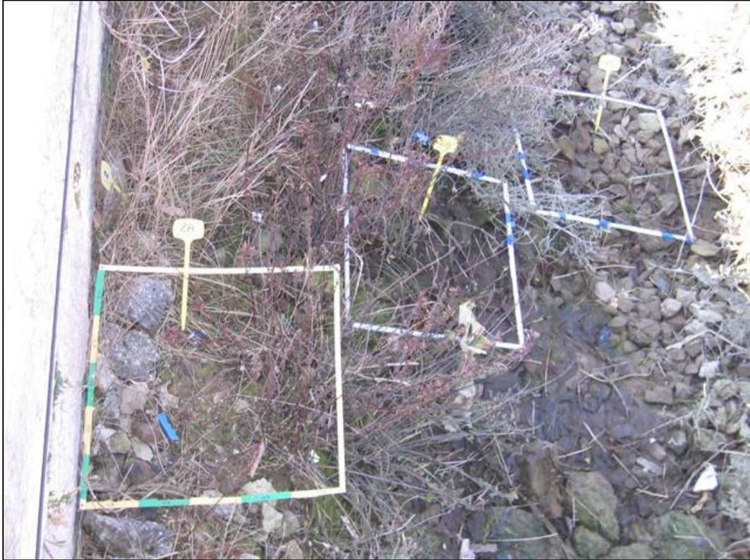
Foto 6.18 – Stazione 2: posizionamento delle tre repliche lungo un transetto rivolto dal margine della diga (replica A) verso la parte più infossata della pozza di sifonamento (replica C).
