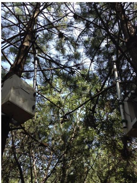
Figura 67. Foto delle due centraline: a destra, la centralina di misura; a sinistra, la centralina per le registrazioni audio.
