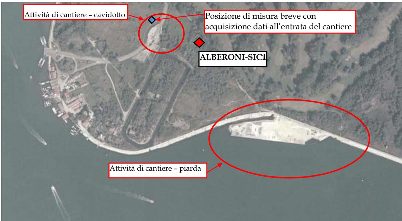
Figura 58: Individuazione della postazione di misura in continuo, della postazione di misura con acquisizione dei dati audio (coincidenti per le misure spot eseguite in data 01/10/07 e 16/05/08) e dell'area di cantiere.
