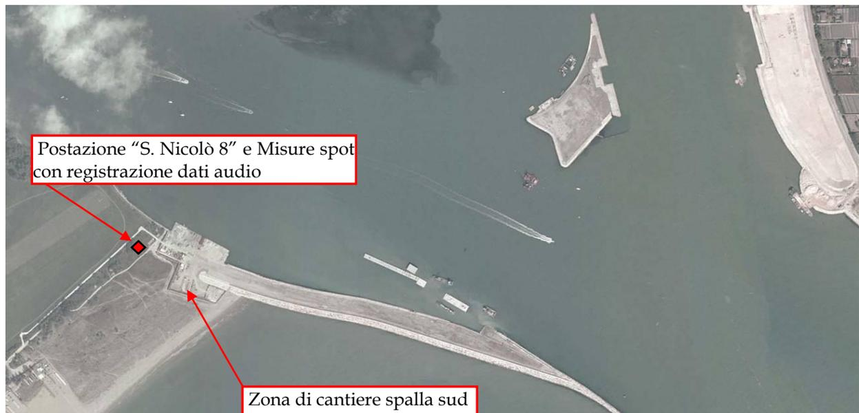
Figura 53: Individuazione della postazione di misura in continuo, della postazione di misura con acquisizione dei dati audio e dell'area di cantiere.
