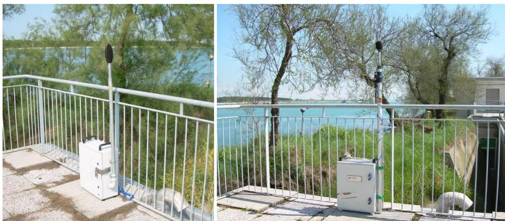
Figura 36. Foto del posizionamento dei due tipi di centraline di rumore utilizzate a PELLESE1.
