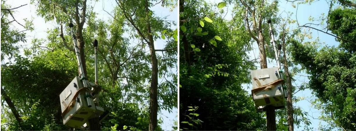
Figura 96: Foto della centralina di monitoraggio e dell'asta con microfono dello strumento preposto alle registrazioni audio
