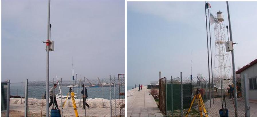
**Figura 28. Posizionamento centralina sul palo d'illuminazione della zona faro di Chioggia , molo spalla sud Sottomarina, punto rilievo SOTTOM3.**
