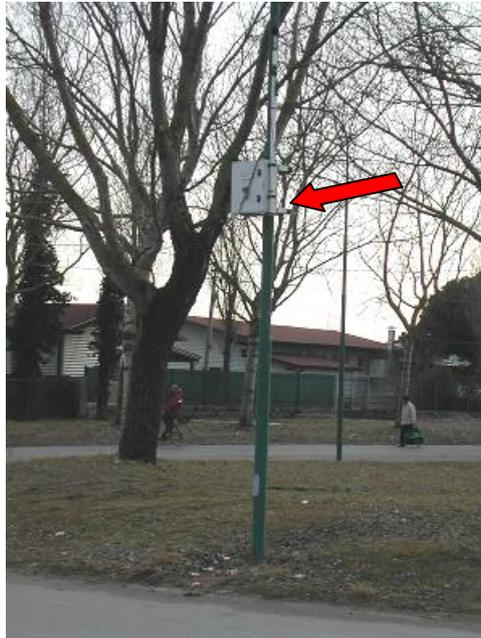
Figura 10. Posizionamento della centralina su palo illuminazione pubblica di viale Umberto Klinger, posizione rilievo SNICOL2.
