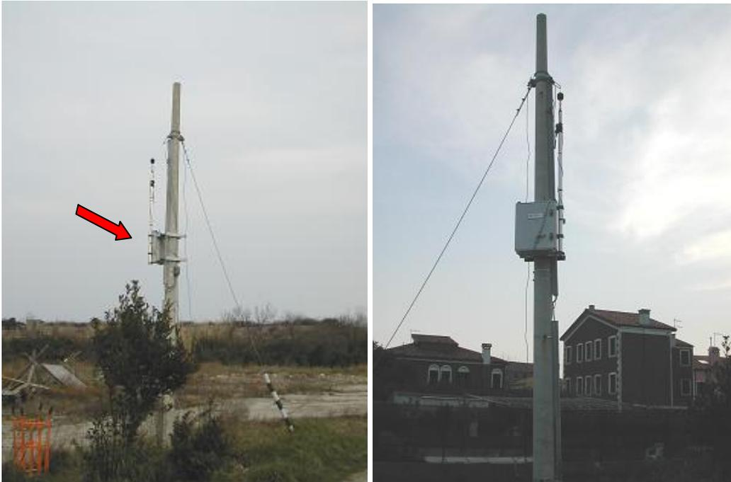
Figura 20. Posizionamento centralina sul palo della Telecom scollegato a S. Pietro in Volta.
