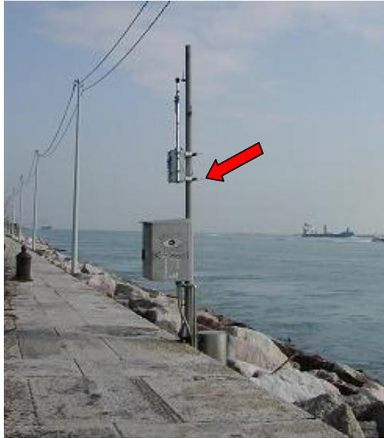
Figura 15. Posizionamento centralina sul palo della centralina idrofoni CVN, punto rilievo ALBERO2.
