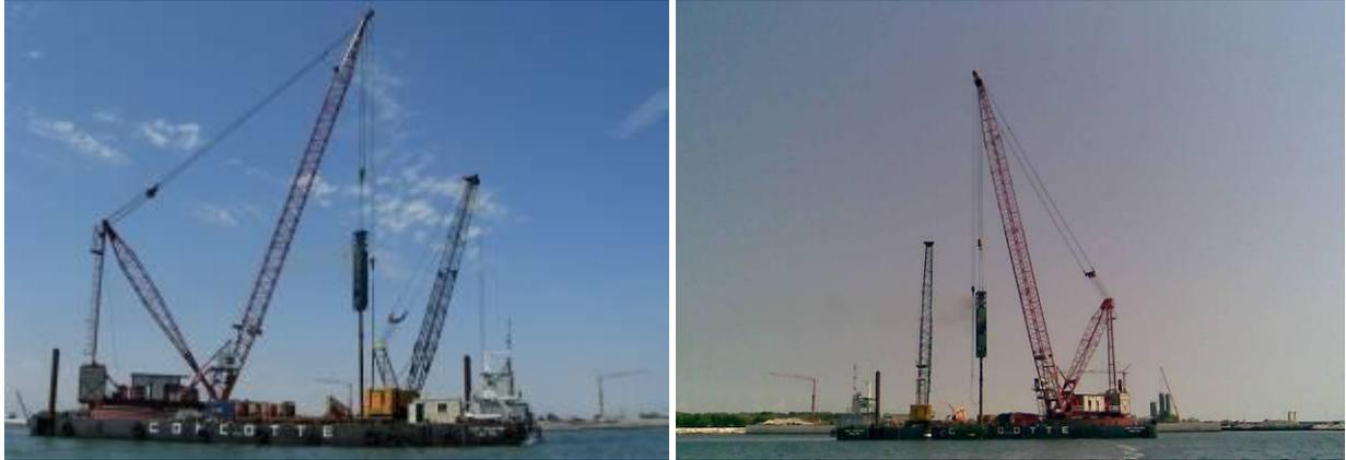
Figura 62: Foto del pontone con il battipalo (scattate rispettivamente il 19 giugno e il 14 luglio 2009)
