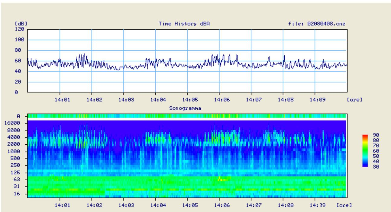
Figura 27: Profilo temporale e sonogramma rilevati ad ALBERONI-SIC1 martedì 8 Aprile. Si può notare il canto degli uccelli e le lavorazioni provenienti dalla piarda, dal cantiere del cavidotto e dal cantiere sulla strada.
