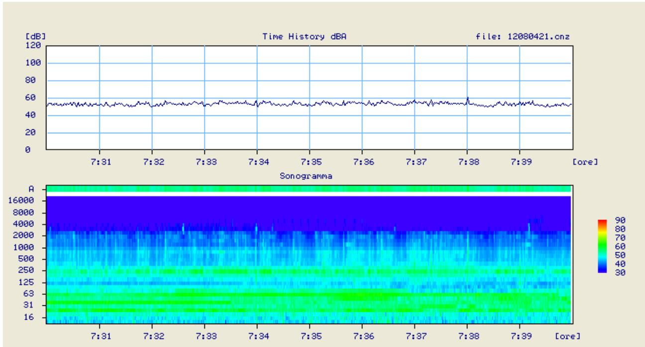
Figura 33: Profilo temporale e sonogramma rilevati nella postazione "ALBERONI-SIC3", estratto di 10 minuti. Lavorazioni molto rumorose alle ore 07:30 del giorno 21 Aprile 2008.
