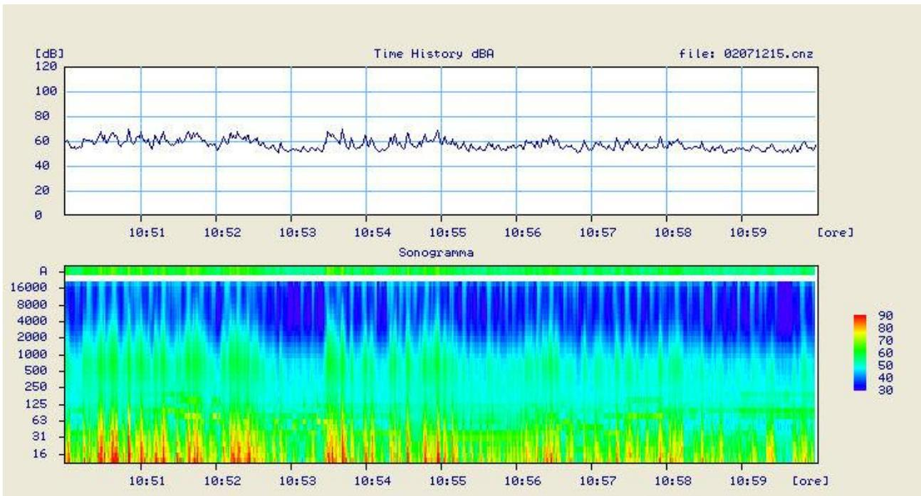
Figura 45: Profilo temporale e sonogramma rilevati a CAROMA1. Si nota la presenza di eventi meteorologici, in particolare vento molto intenso.
