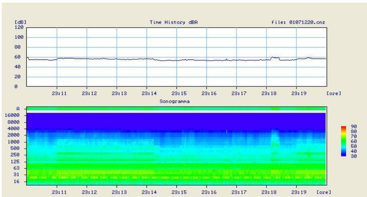
Figura 25: Profilo temporale e sonogramma della tipica attività di cantiere rilevata ad ALBERONI-SIC1, proveniente dal cantiere del cavidotto. Si può notare come tale attività sia proseguita anche durante una parte del periodo notturno in data 20 dicembre 2007.
