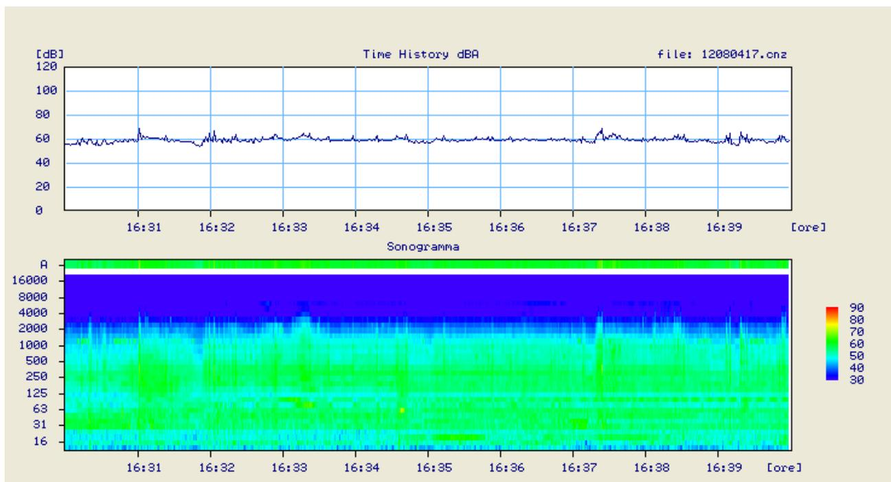
Figura 32: Profilo temporale e sonogramma rilevati nella postazione "ALBERONI-SIC3", estratto di 10 minuti. Spettro tipico della lavorazione della piattaforma a ragno.
