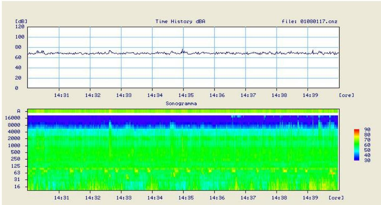
Figura 6: Profilo temporale e sonogramma rilevati nella postazione "RIST. BACARO", registrati in data 17 gennaio 2008. Il sonogramma evidenzia una tipica attività di cantiere rilevata in questa postazione, caratterizzata dal versamento di pietrisco dalla chiatta per la formazione della scogliera, effettuato da una piattaforma a ragno.
