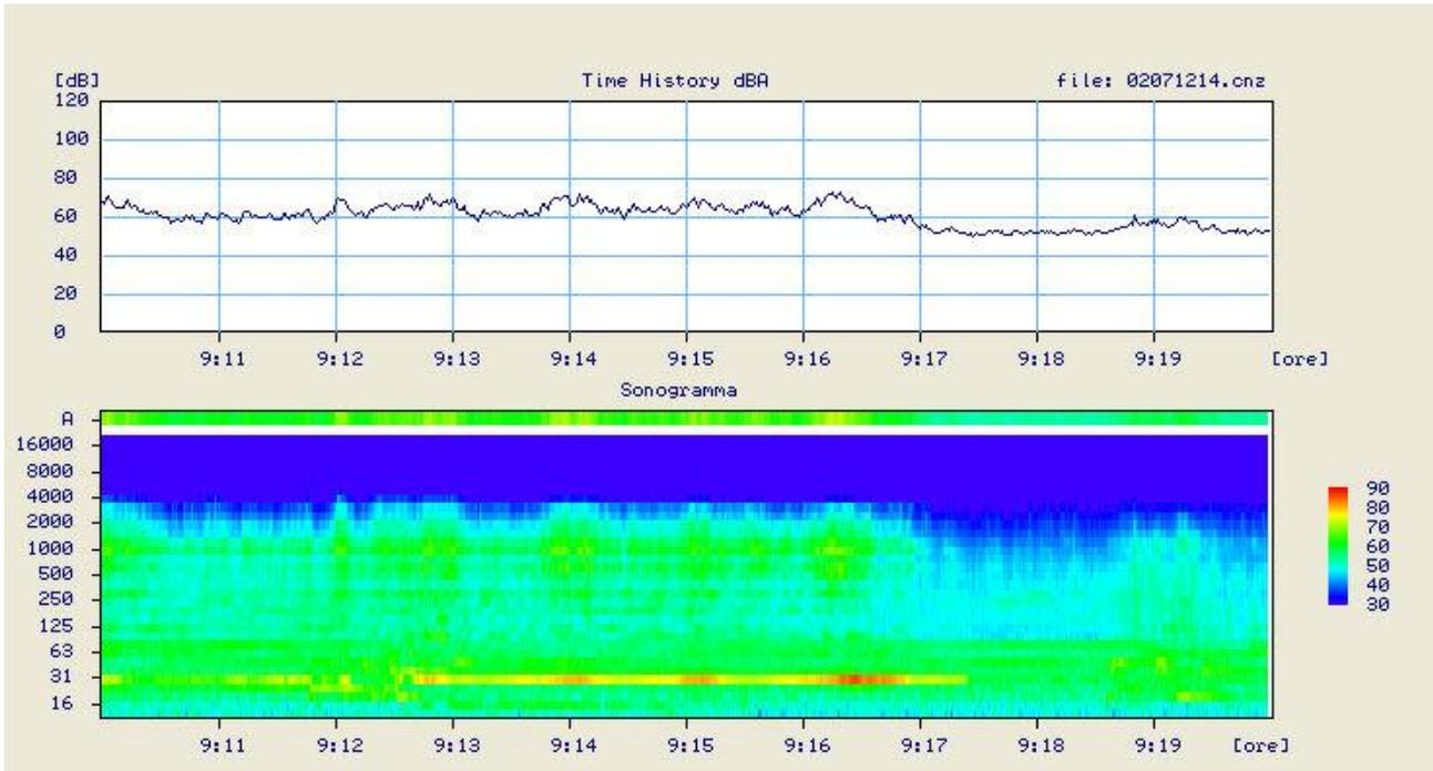
Figura 44: Profilo temporale e sonogramma di attività di cantiere (vibroinfissione palancole) di rumorosità molto elevata rilevate a CAROMA1.
