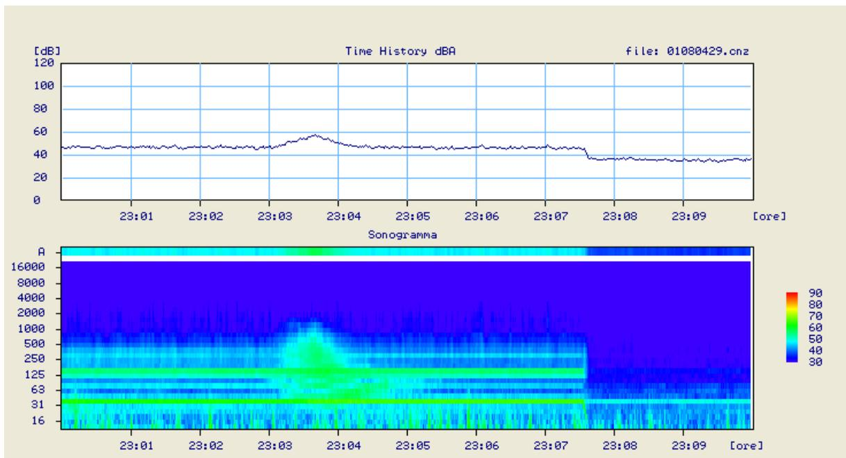
Figura 17: Profilo temporale e sonogramma rilevati nella postazione "S. Nicolò 8", estratto di 10 minuti. Spegnimento del gruppo elettrogeno alle ore 23:07 circa.
