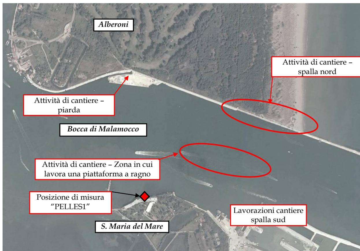
Figura 35: Individuazione postazione di misura "PELLES1" ed aree di cantiere
