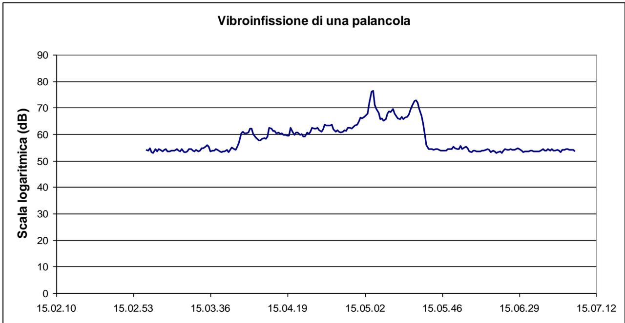
Figura 47: Profilo temporale relativo alla vibroinfissione di una palanca, visualizzazione in scala logaritmica (dB)
