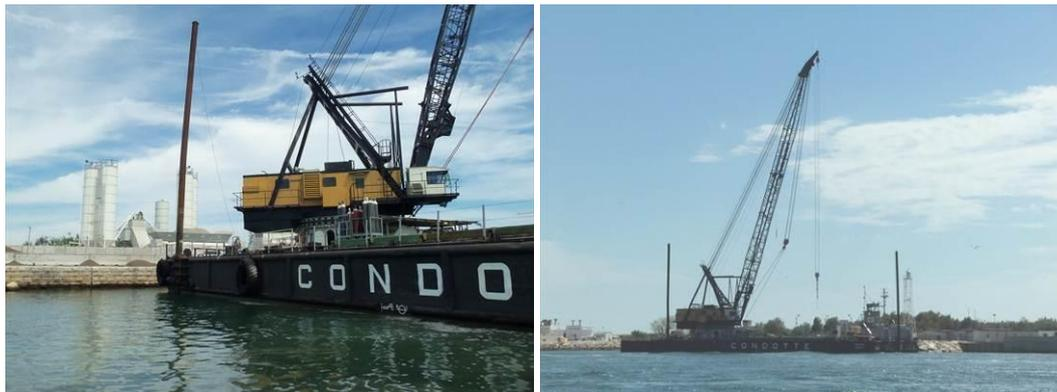
Figura 81: Foto del motopontone impiegato per il trasporto dei mezzi di cantiere mentre attracca sulla spalla Nord (a sinistra), e mentre attracca sulla spalla Sud (a destra). Immagini scattate il 30 Agosto 2012.
