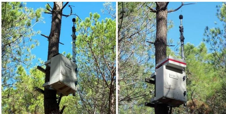
Figura 16: Foto della centralina di monitoraggio, a sinistra scattata il 14 Settembre, a destra scattata il 30 Ottobre, con installato un box aggiuntivo per l'impiego di due ulteriori kit di batterie.
