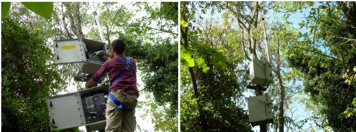
Figura 5. Centralina di rumore ad Alberoni-SIC1 con particolare del montaggio.
