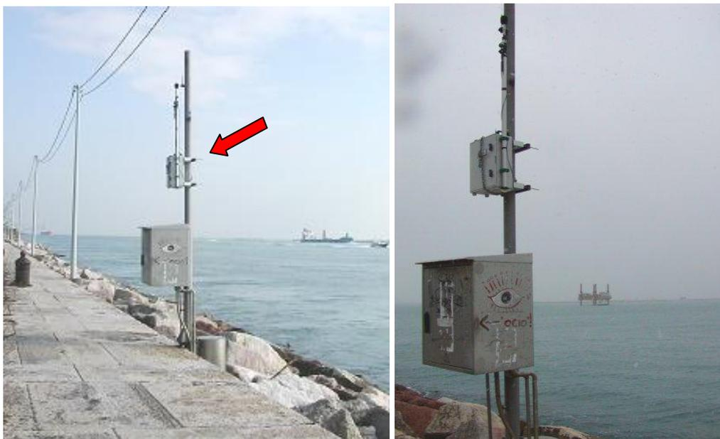
Figura A2.37. Posizionamento centralina sul palo della centralina idrofoni CVN, punto rilievo ALBERO2.
