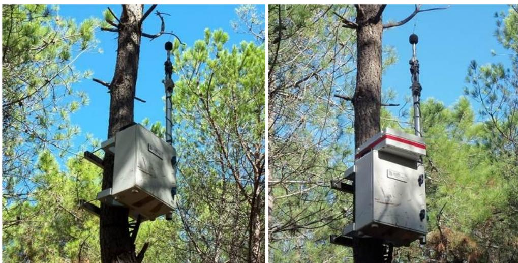
Figura 9: Foto della centralina di monitoraggio, a sinistra scattata il 14 Settembre, a destra scattata il 30 Ottobre, con installato un box aggiuntivo per l'impiego di due ulteriori kit di batterie.
