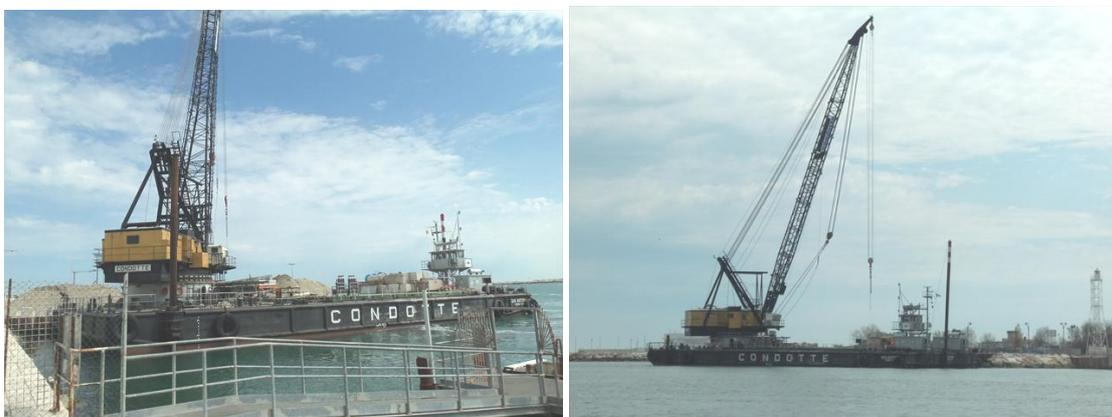
Figura 37: Foto del motopontone impiegato per il trasporto di materiale e mezzi di cantiere mentre attracca sulla spalla Nord (a sinistra), e mentre attracca sulla spalla Sud (a destra). Immagini scattate il 16 Aprile.
