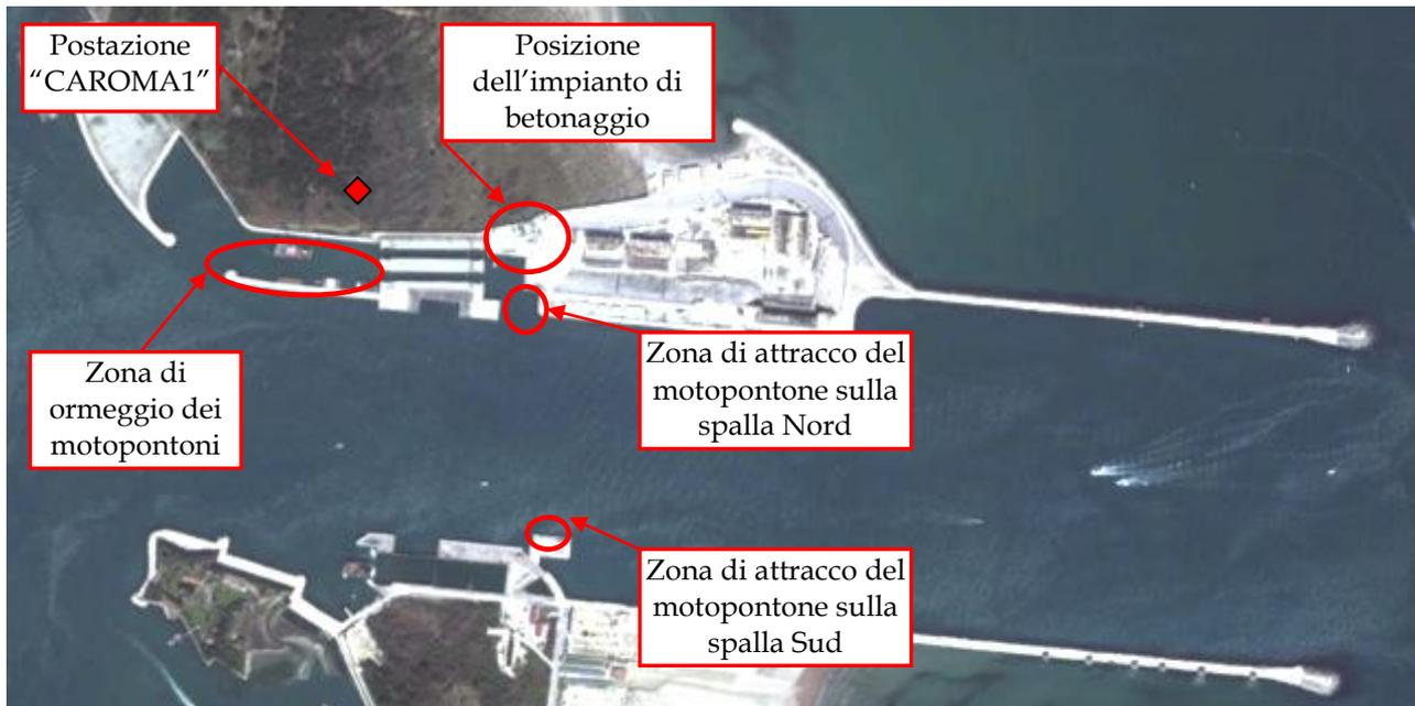
Figura 39: Individuazione della postazione di misura CAROMA1, della posizione dell'impianto di betonaggio, della zona di ormeggio dei motopontoni nel porto rifugio e della zona di attracco del motopontone impiegato per il trasporto dei mezzi di cantiere sulla spalla Nord.
