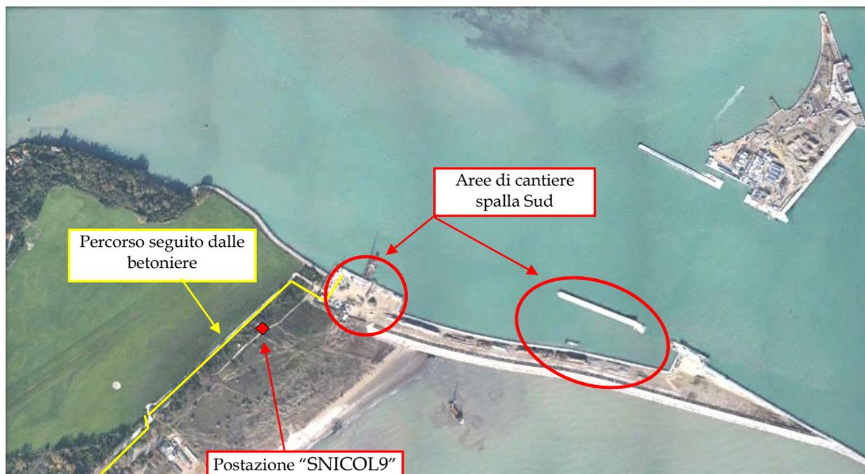
Figura 2: Individuazione della postazione di misura SNICOL9, delle aree di lavorazione presso il cantiere della spalla Sud, e del tragitto percorso dalle betoniere.
