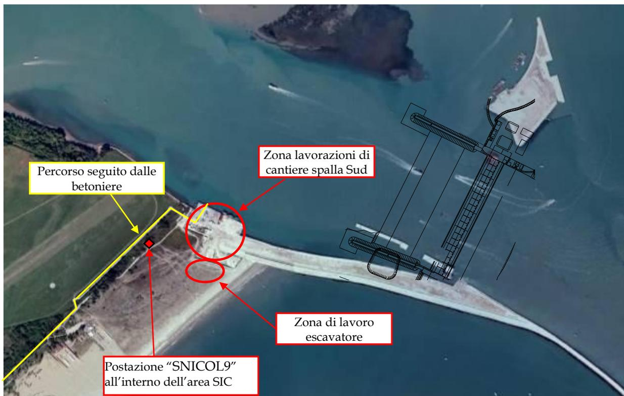
Figura 48: Foto aerea di parte della Bocca di Lido con individuazione della postazione di misura, del tragitto percorso dalle betoniere, della zona di lavoro dell'escavatore e della zona delle lavorazioni presso il cantiere della spalla Sud.
