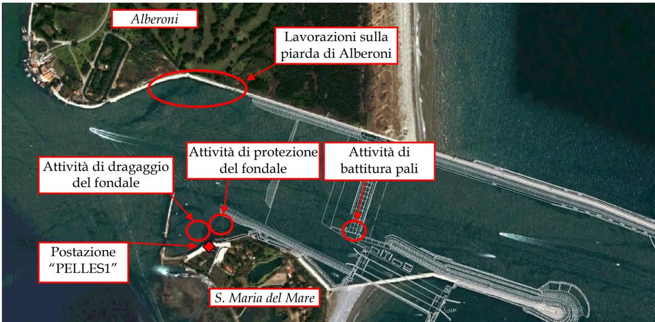
Figura 17: Individuazione della postazione di misura "PELLES1" e delle zone in cui sono presenti le attività di cantiere rilevate in tale postazione.
