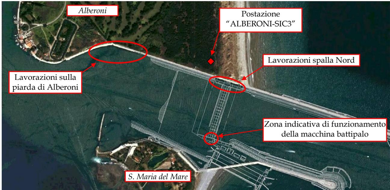
Figura 2: Individuazione della postazione di misura "ALBERONI-SIC3" e delle zone in cui sono presenti le attività di cantiere più rumorose rilevate in tale postazione.
