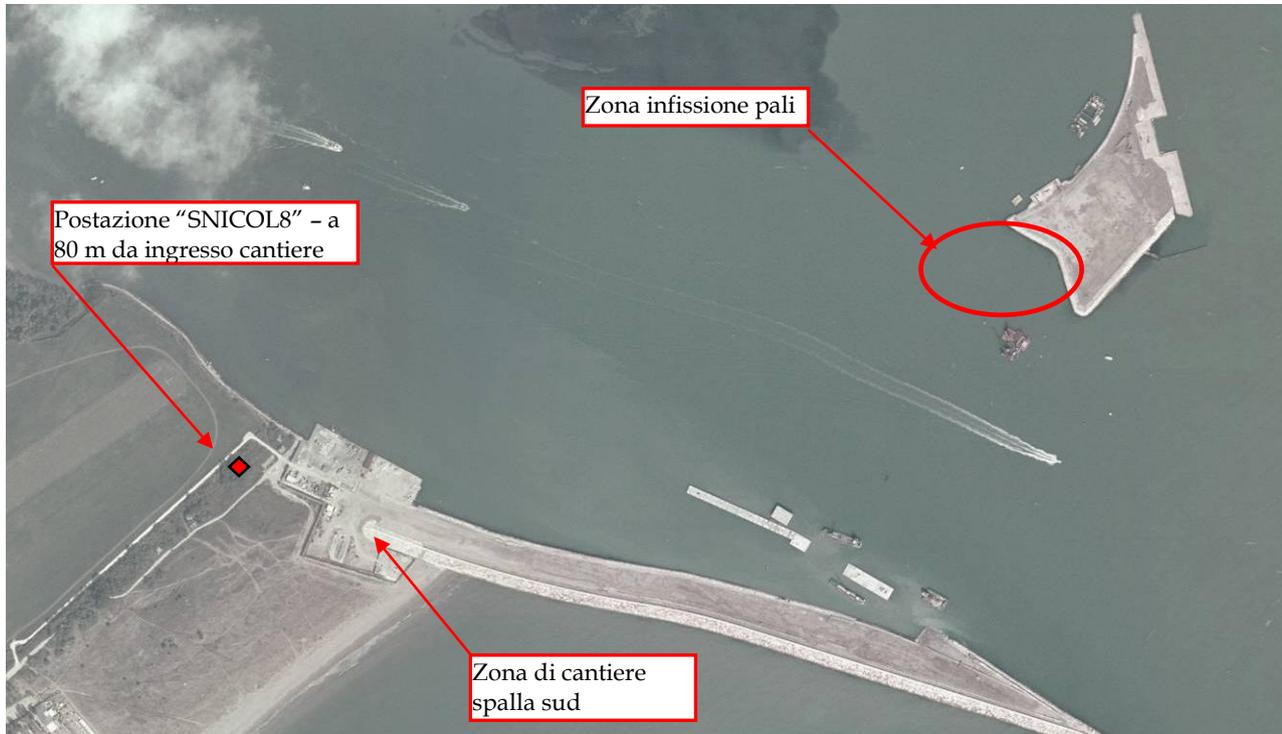
Figura 1: Foto aerea della Bocca di Lido con individuazione della postazione di misura "SNICOL8", dell'area di infissione pali e della zona di cantiere nella spalla sud
