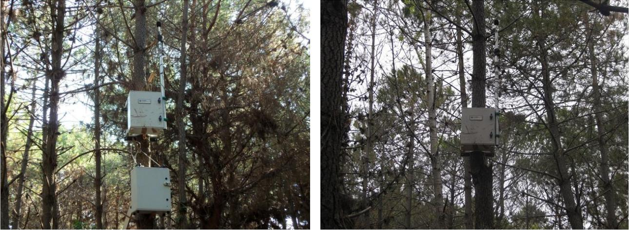
Figura 3: Foto della centralina di monitoraggio, a sinistra con il box aggiuntivo per le batterie di alimentazione utilizzato nel primo periodo di monitoraggio, a destra nella configurazione del secondo periodo di monitoraggio.
