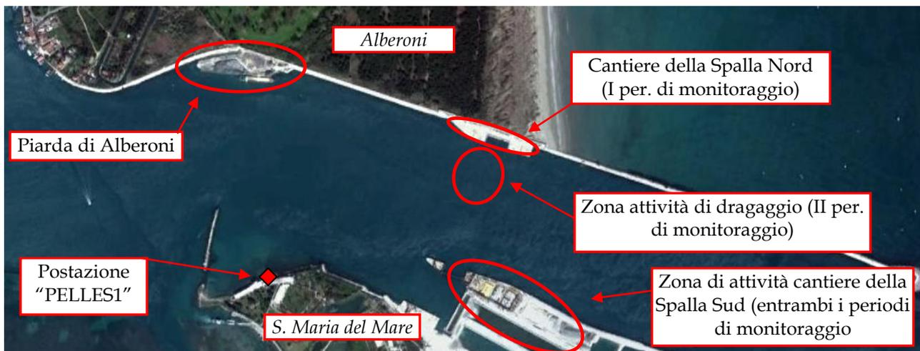
Figura 31: Individuazione della postazione di misura "PELLES1" e delle zone in cui sono presenti le attività di cantiere.
