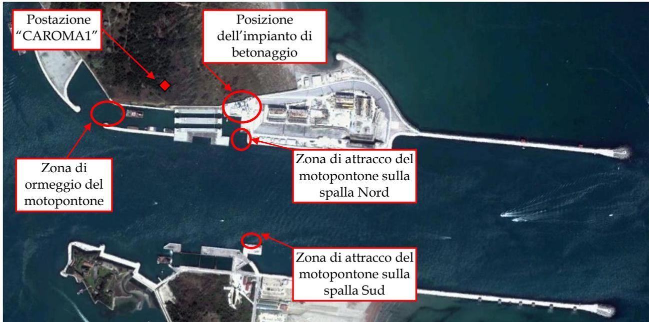
Figura 51: Individuazione della postazione di misura CAROMA1, della posizione dell'impianto di betonaggio, della zona di ormeggio del motopontone nel porto rifugio e della zona di attracco sulla spalla Nord.
