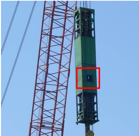
Figura 6: Foto della macchina battipalo con schermatura acustica. Si nota la mancanza dello sportello di chiusura dell'apertura di manutenzione. Foto scattate in data 23 Settembre 2008
