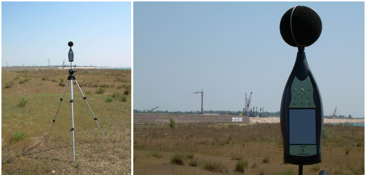
Fig. 10. Sistemazione e veduta del cantiere dalla postazione di misura di breve durata SNICOL6.
