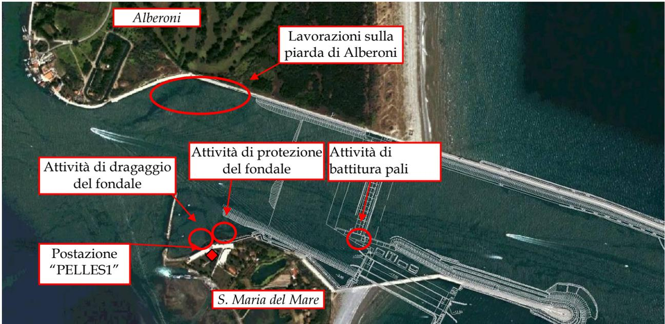
Figura 75: Individuazione della postazione di misura "PELLES1" e delle zone in cui sono presenti le attività di cantiere rilevate in tale postazione.
