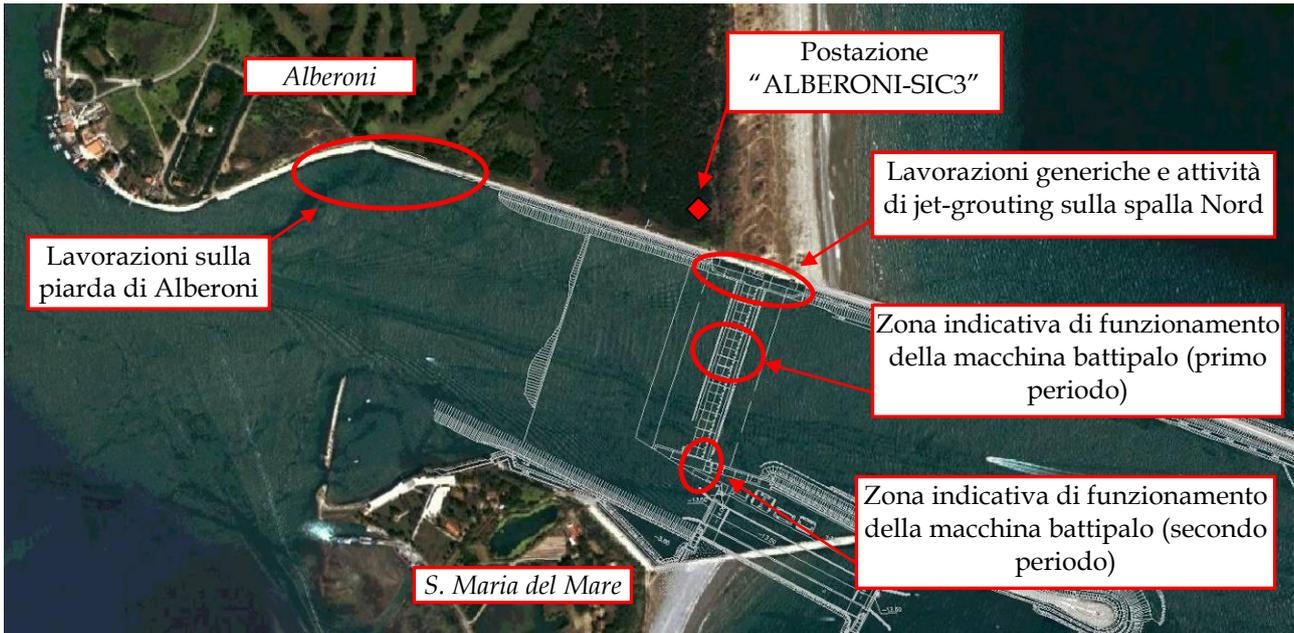
Figura 40: Individuazione della postazione di misura "ALBERONI-SIC3" e delle zone in cui sono presenti le attività di cantiere più rumorose rilevate in tale postazione.
