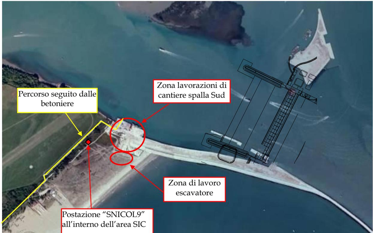
Figura 24: Foto aerea di parte della Bocca di Lido con individuazione della postazione di misura, del tragitto percorso dalle betoniere, della zona di lavoro dell'escavatore e della zona delle lavorazioni presso il cantiere della spalla Sud.
