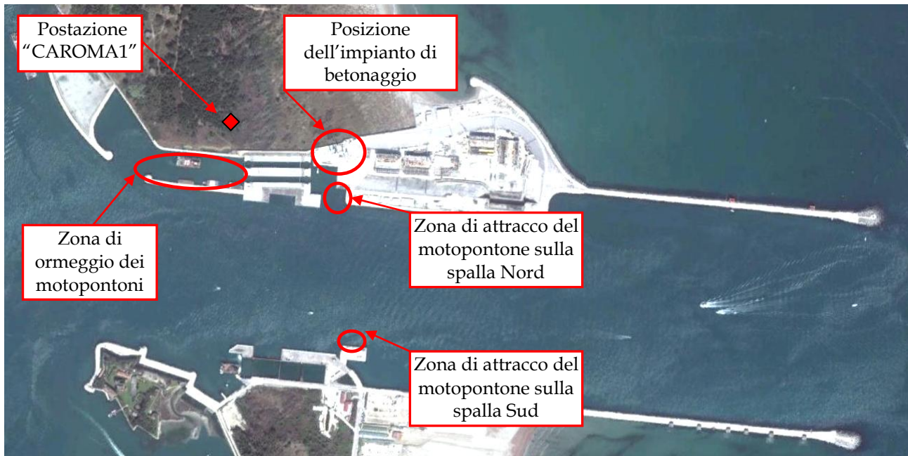
Figura 14: Individuazione della postazione di misura CAROMA1, della posizione dell'impianto di betonaggio, della zona di ormeggio dei motopontoni nel porto rifugio e della zona di attracco del motopontone impiegato per il trasporto dei mezzi di cantiere sulla spalla Nord.
