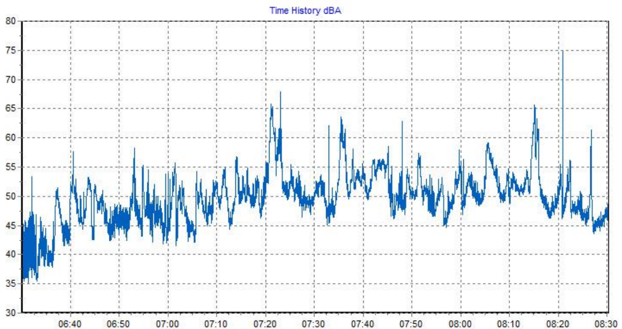
Figura 8: Profilo temporale al secondo rilevato in data 07 Maggio 2014 . Sono visibili vari rumori connessi alle attività di cantiere.
