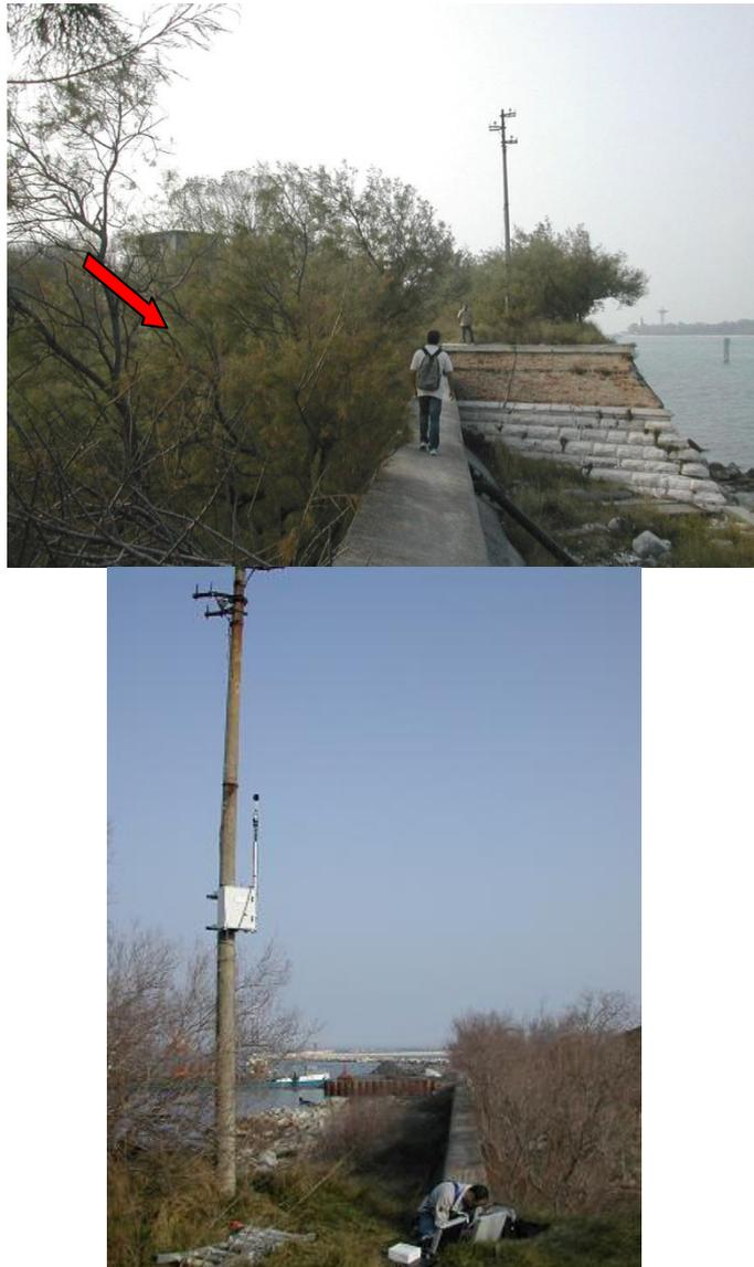
**Figura 15. Posizionamento centralina sul palo della luce abbandonato, al molo spalla sud della bocca di Malamocco, punto rilievo *PELLES2*.**
