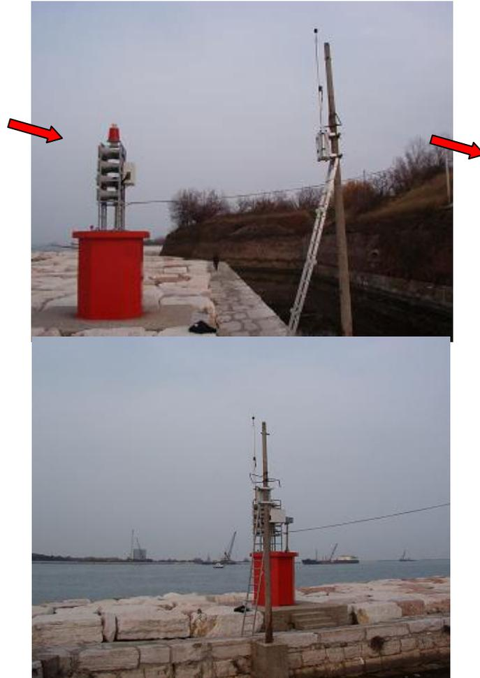
**Figura 20. Posizionamento centralina sul palo luce abbandonato, molo spalla sud Sottomarina, punto rilievo *SOTTOMI*.**
