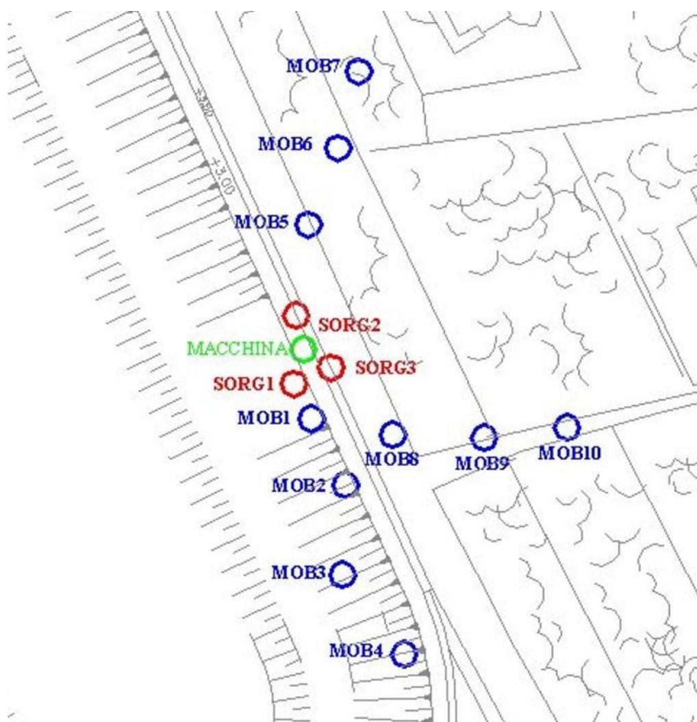
Figura 8. Dislocazione della macchina "BAUER BG 28" con un cerchio verde. Dislocazione delle postazioni fisse SORG01, SORG02 e SORG03 con cerchi rossi. Dislocazione delle postazioni MOB01, MOB02, MOB03, MOB04, MOB05, MOB06, MOB07, MOB08, MOB09, MOB10 con cerchi blu.
