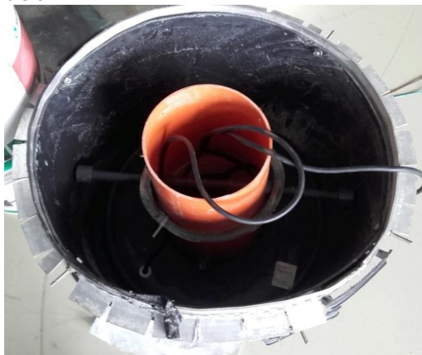
Figura 1. Schema della camera bentica troncoconica toroidale (sinistra) e foto del primo prototipo (destra). S = sonda; C = contenitore di alloggiamento della sonda; P = pompa; D = diffusori; F = flangia; s = sedimento.
