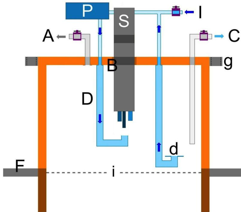
Figura 14. Schema della camera cilindrica che verrà testata nel mese di marzo 2020. S = sonda; P = pompa; D = diffusori; F = flangia; B = manicotto; I = ingresso per innesco pompa; A = sfiato aria; C = collegamento per prelievo campioni d'acqua; i = interfaccia acqua-sedimento; g = guide metalliche; f = fori per inserimento di aste in acciaio; d = dischetto. La camera mostrata in Figura è la versione "accorciata".
