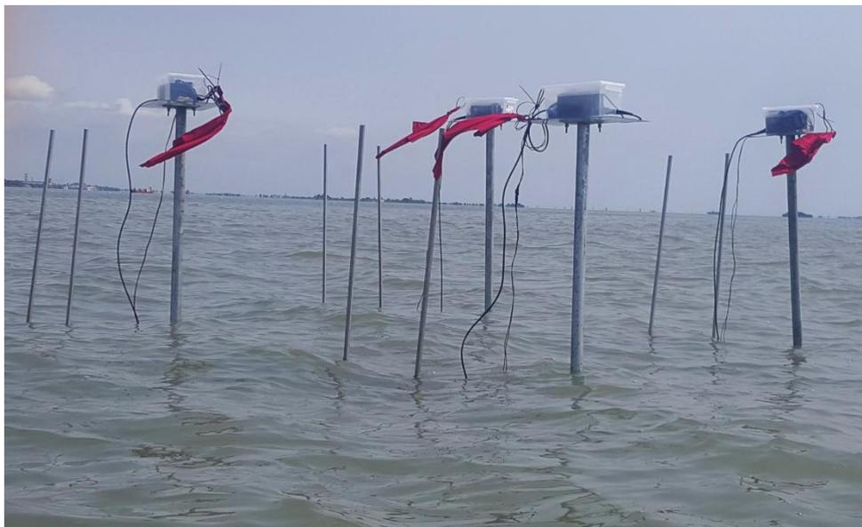
Test di quattro camere bentiche poste ad operare nello stesso sito per misure test.
