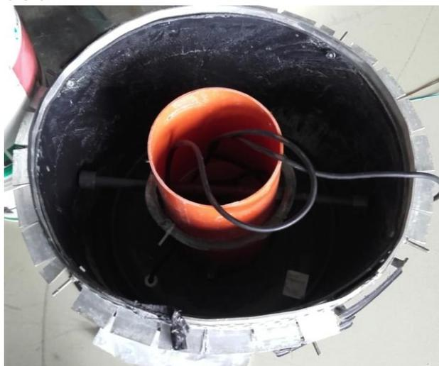
Figura 1. Schema della camera bentica troncoconica toroidale (sinistra) e foto del primo prototipo (destra). S = sonda; C = contenitore di alloggiamento della sonda; P = pompa; D = diffusori; F = flangia; s = sedimento.
