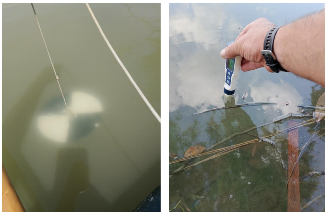
Figura 7. Misurazione della trasparenza tramite disco di Secchi (a sinistra) e misurazione pH con strumento elettronico (a destra).
