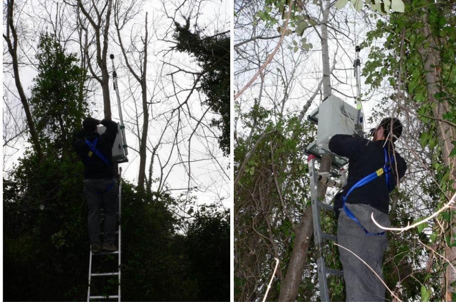
Figura 2.2. Particolare del montaggio delle centraline di rumore ad ALBERONI-SIC1 (a sinistra), e ad ALBERONI-SIC2 (a destra) - campagna di monitoraggio primaverile
