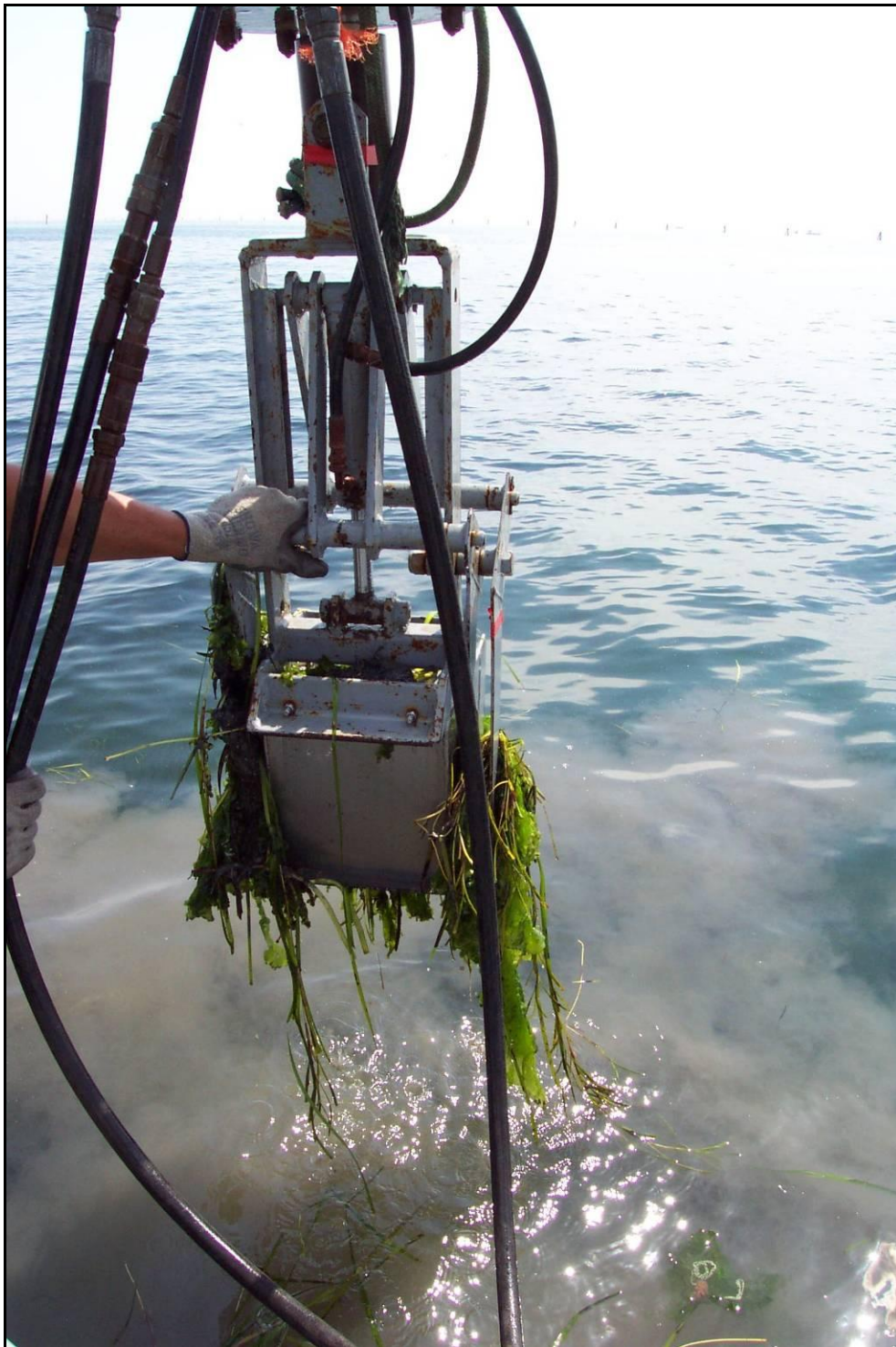
Fig 2.5 BOX CORER per il campionamento del sedimento per il rilievo della comunità macrozoobentonica comandato mediante braccio meccanico-idraulico.
